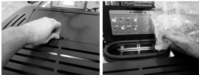
Figura 133 – Abastecimento do depósito de pellets
